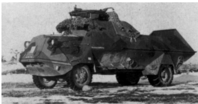
Рис. 2. БТР М-42 с башенкой (непосредственно за ней находится место, где хранится брезентовое покрытие)
