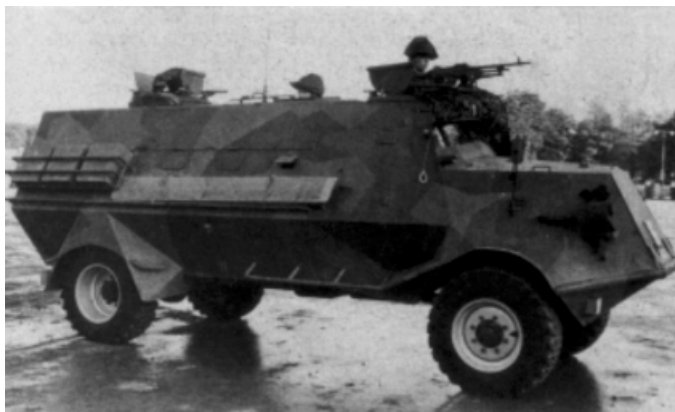
Рис. 1. Модернизированный БТР SKPF М-42 (в носовой и хвостовой части установлены два 7,62-мм пулемета)
